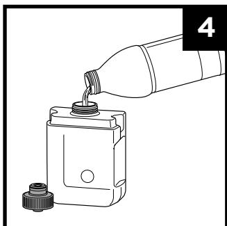
**4** Uklonite rezervoar za uklanjanje mrlja sa uređaja i okrenite ga. Odvrnite čep i sipajte StainStriker formulu u rezervoar.
