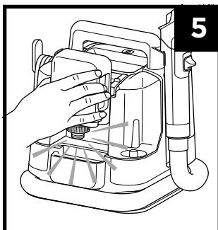
**5** Vratite čep i ponovo instalirajte rezervoar dok ne zaklupi na mesto.
