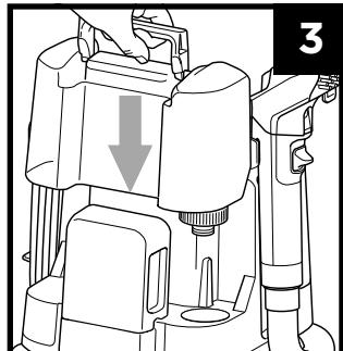
**3** Vratite čep, a zatim ponovo instalirajte rezervoar dok ne klikne.
