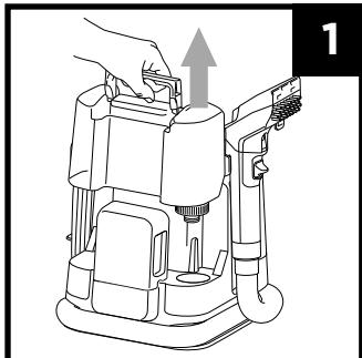
**1** Uklonite rezervoar za dubinsko čišćenje Pro sa uređaja. Okrenite rezervoar, odvrnite čep i uklonite ga.
