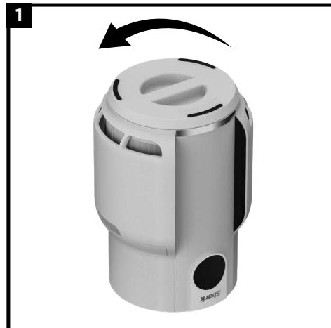
1 NE priključujte prečišćivač vazduha u struju. Prvo pažljivo okrenite prečišćivač vazduha naopakice i postavite ga na ravnu površinu. Okrenite vrata filtera u smeru suprotnom od kazaljke na satu da biste ih otključali, zatim ih podignite kako biste pristupili HEPA filteru.
