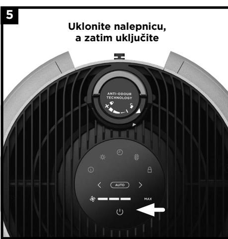
5 Pažljivo uklonite žutu nalepnicu sa vrha prečišćivača vazduha kako biste pristupili kontrolnoj tabli. Priključite prečišćivač u električnu utičnicu i pritisnite dugme za uključivanje na gornjoj kontrolnoj tabli.
