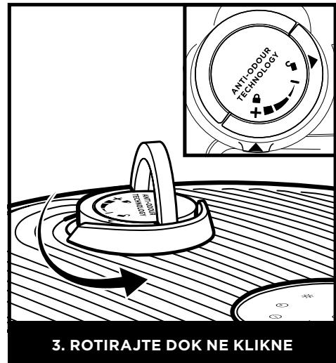
Da biste zaključali i aktivirali sklop uloška za mirise, rotirajte ga suprotno od kazaljke na satu dok ne klikne najmanje jednom. Nastavite da rotirate regulator ka poziciji visokog intenziteta kako biste povećali intenzitet.
