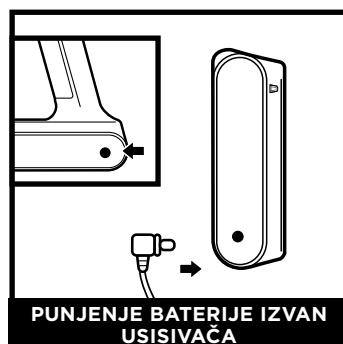
Pritisnite i držite dugme za otpuštanje baterije (Battery Release Button), zatim izvucite bateriju. Priključite punjač u port za punjenje na bateriji. Da biste ponovo postavili bateriju, umetnite je u otvor na zadnjoj strani ručnog usisivača.
